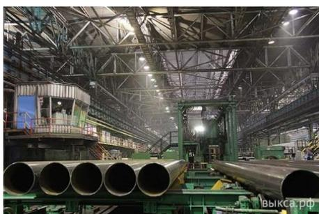
Технический проект оборудования трубоэлектросварочного агрегата «203-530» был разработан Электростальским заводом тяжёлого машиностроения. Подготовка площадки под строительство цеха началась в феврале 1973 года. ТЭСЦ-3 был пущен в работу в декабре 1977 года. В его составе – трубоэлектросварочный стан «203-530», участок объёмной термообработки труб с двумя печами нормализации, участок отделки.
