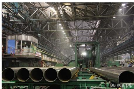
Он специализируется на выпуске нефтегазопроводных труб диаметром от 219 до 530 мм с толщиной стенки до 12,7 мм. Кроме того, подразделение выпускает профильные трубы (квадратные от 160x160 мм до 300x300мм) для нужд строительной индустрии. В цехе работает ТЭСА 203-530 с номинальной годовой производительностью 650 тыс. тонн. В 2011-2012 годах была проведена модернизация линии с установкой новой входной части стана от немецкой компании
